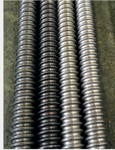
Bild 8: Gewindespindeln mit unterschiedlicher Schutzgasbeaufschlagung
