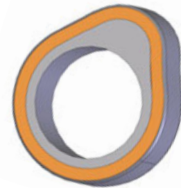
Härtebereich einer Einzelnocke
