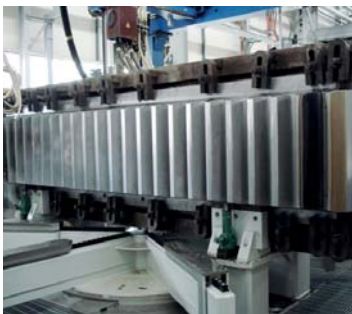
Zahnstangen und Werk- stückhalter vor der Härte- behandlung.
